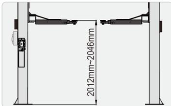
Erreicht eine maximale Hubhöhe von über 2 Metern, ohne dass zusätzliche Adapter benötigt werden.
