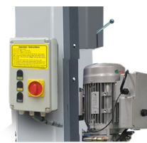
Elektronisch besturings-systeem met eenzijdige ontgrendeling
