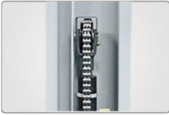
Doppelte Hydraulikzylinder mit Ketten-Umlenkrollensystem für maximale Hubhöhe.
